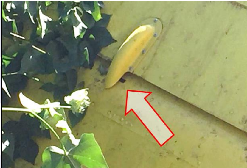
Figura 5 - Detalhe da marca de indicação de 10^\circ de flape da asa esquerda após o acidente.
