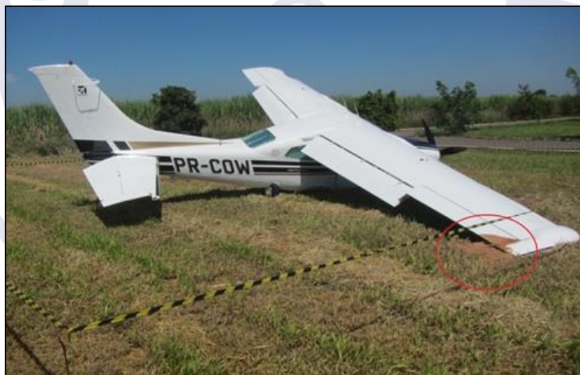
Figura 2 - Indicação de vazamento de combustível na asa direita.
