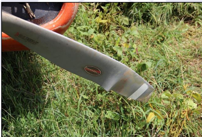
Figura 2 - Amolgamento da pá da hélice.
