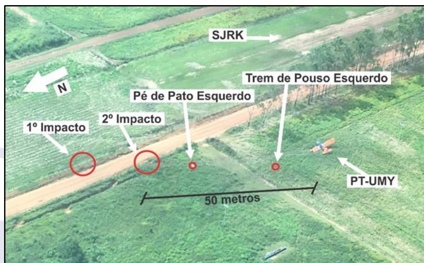
Figura 3 - Localização dos pontos de impacto e destroços.
