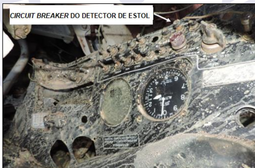
Figura 3 - Imagem do painel mostrando a situação do disjuntor do detector de estol.
