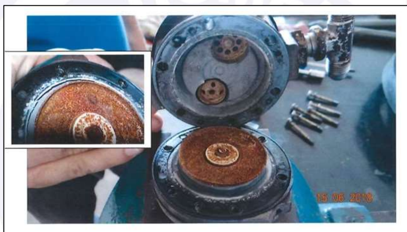
Figura 15 - Componentes desgastados da bomba de combustível do PT-OQX.
