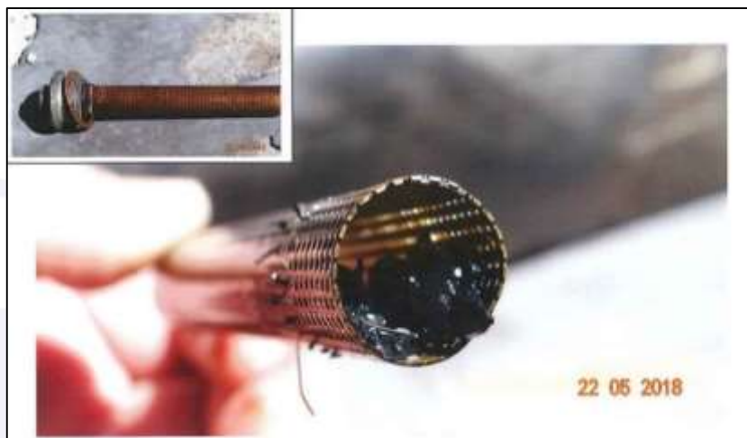
Figura 7 - Vista do filtro de óleo primário.
