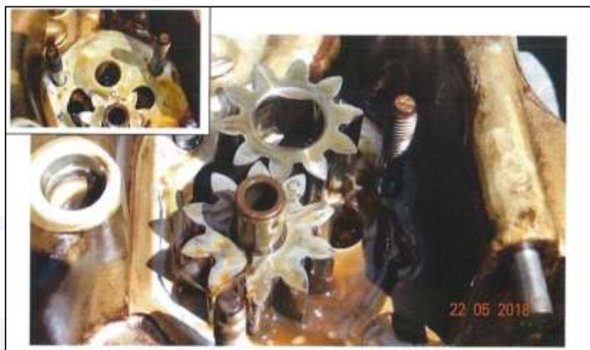
Figura 9 - Visão geral da bomba de óleo do motor.
