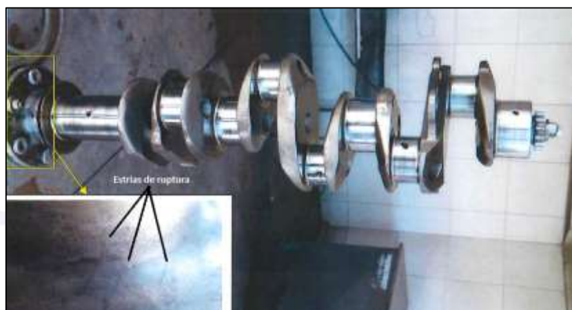
Figura 19 - Eixo de manivelas. Em destaque, região do flange de acoplamento com a hélice.
