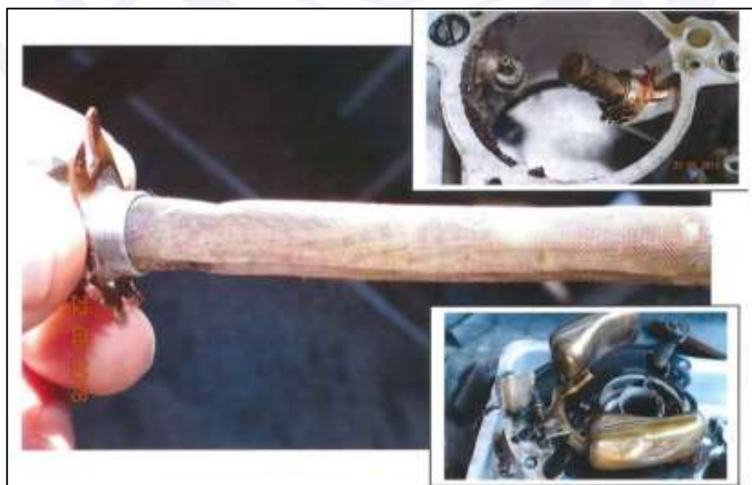
Figura 11 - Filtro de entrada de combustível e carburador.
