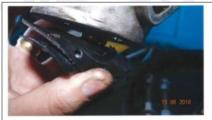
Figura 16 - Desgaste do diafragma inferior da bomba.
