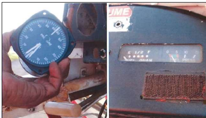
Figura 14 - Vista da pressão de combustível no manômetro instalado entre a bomba e o carburador e no painel da aeronave durante o teste com a bomba de combustível do PT-OQX.
