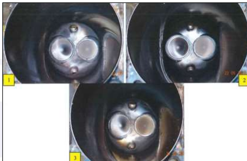
Figura 17 - Cilindros 1, 2 e 3 sem anomalias.
