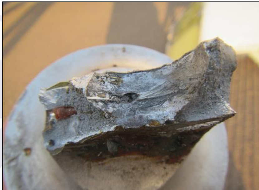
Figura 2 - Fratura no olhal superior de fixação do amortecedor do trem de pouso principal esquerdo.
