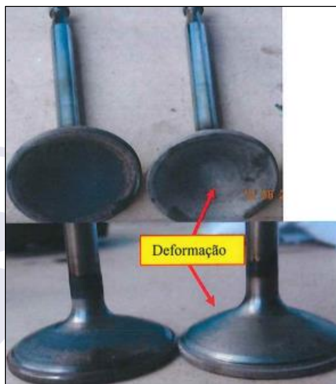
Figura 4 - Válvula de admissão do cilindro 3 deformada, quando comparada com outra normal.
