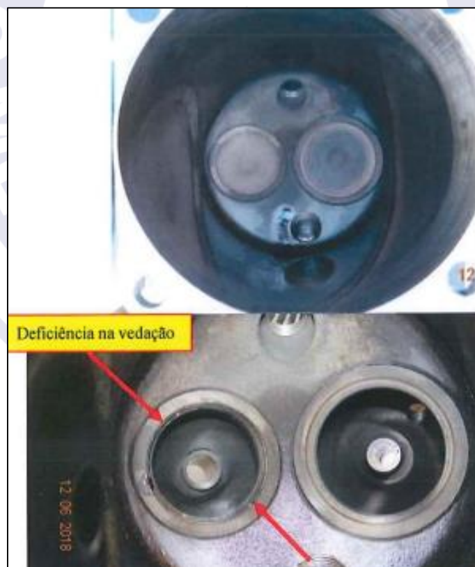
Figura 3 - Deficiência na vedação na sede da válvula de escape do cilindro 3.
