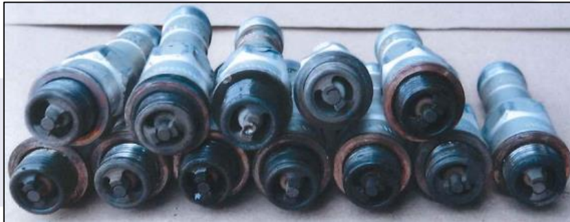
Figura 9 - Visão geral das velas de ignição do motor.
