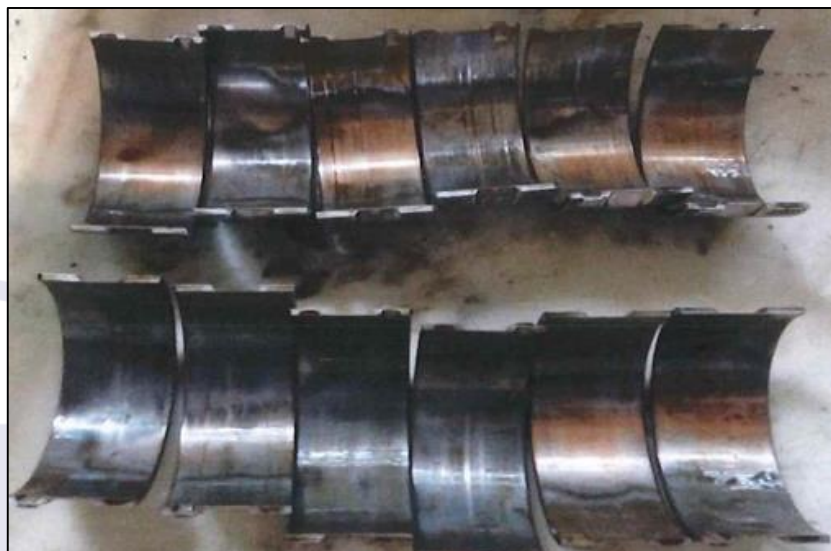
Figura 2 - Vista geral das bronzinas das bielas do motor.
