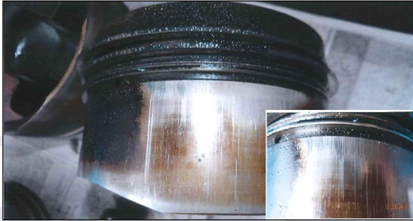
Figura 6 - Pistão do cilindro 4 com riscos e evidência de início de sobretemperatura.
