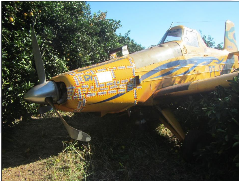
Figura 3 - Danos causados nas pás da hélice
