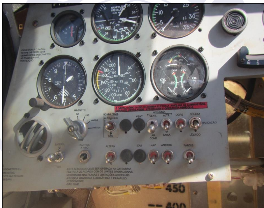
Figura 2 - Inscrição técnica no painel (fundo em carmim).
