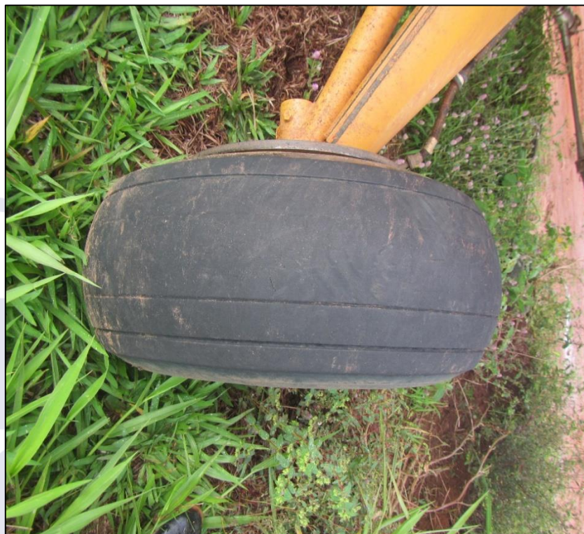
Figura 3 - Pneu esquerdo com sinais de desgaste.
