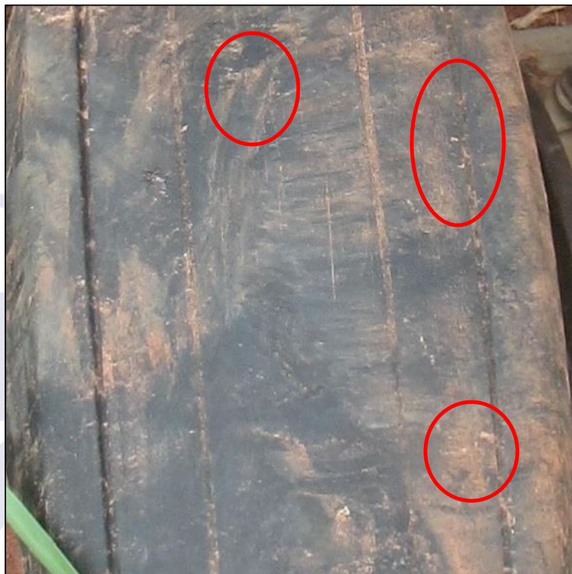
Figura 5 - Pneu direito, em detalhe, com pontos de acentuado desgaste.
