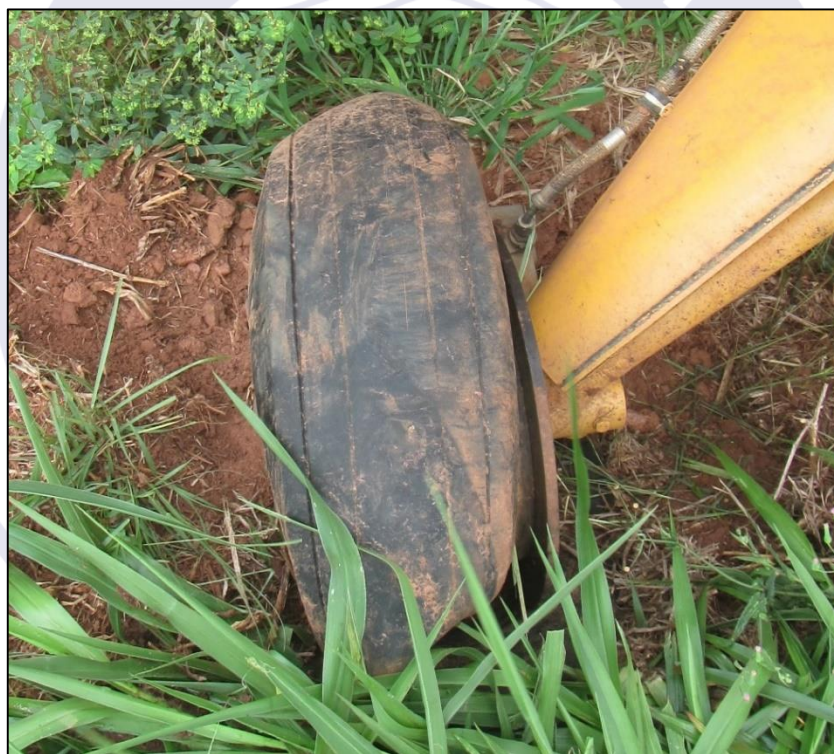
Figura 4 - Pneu direito com sinais de desgaste.
