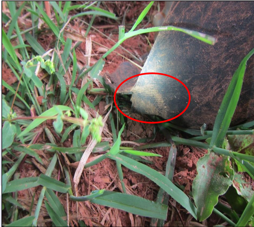
Figura 6 - Pneu direito estourado (marca de “fritada” e rasgo).
