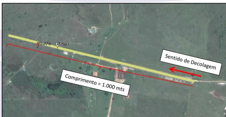
Figura 1 - Sentido de decolagem com posição da fauna e da aeronave após a excursão da pista.
