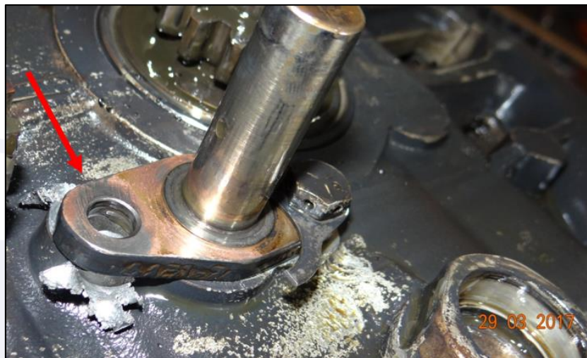
Figura 6 - Detalhe da ausência do prisioneiro de fixação do eixo da engrenagem de acionamento do magneto esquerdo e do comando de válvulas.
