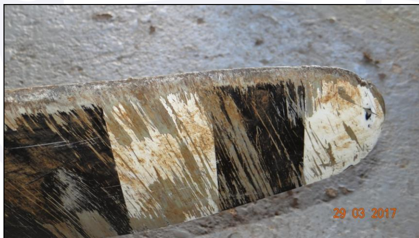
Figura 5 - Marcas de impacto no bordo de ataque e riscos transversais no dorso da pá.
