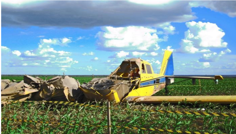
Figura 2 - Danos à seção dianteira da aeronave.
