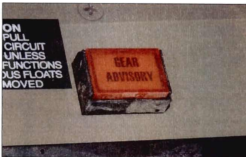
Figura 4 - Botão Gear Advisory instalado na aeronave PR-MPE.
