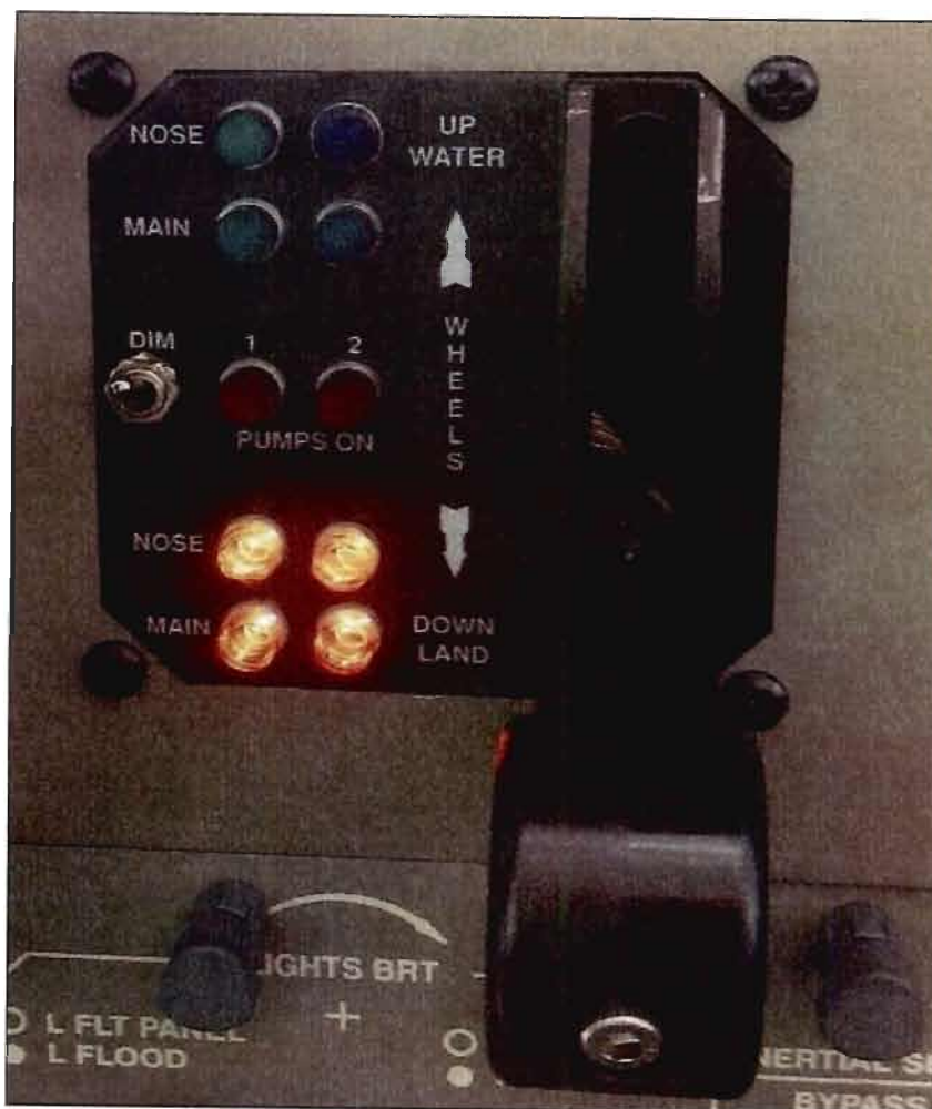
Figura 3 - Sistema de luzes e de comando do trem de pouso do 208 Anfíbio.
