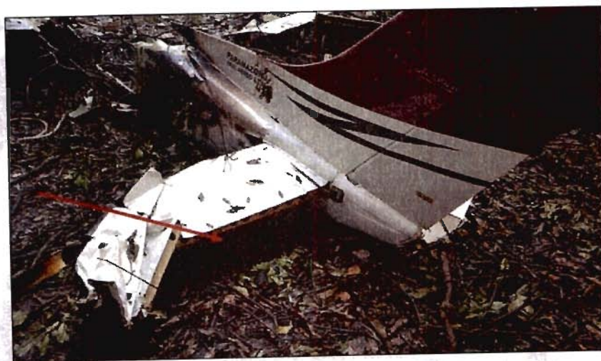
Figura 3 - Estabilizador horizontal esquerdo sem profundor.
