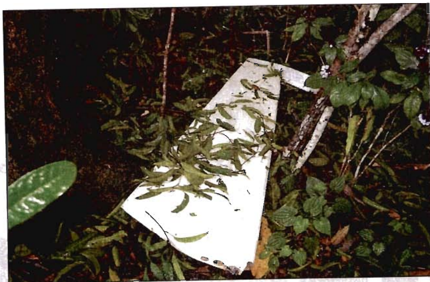
Figura 2 - Profundor esquerdo encontrado próximo ao local do primeiro impacto.
