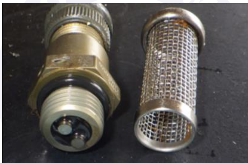
Figura 3 - Detector de limalha e filtro de óleo da caixa de redução do motor sem a presença de limalha.
