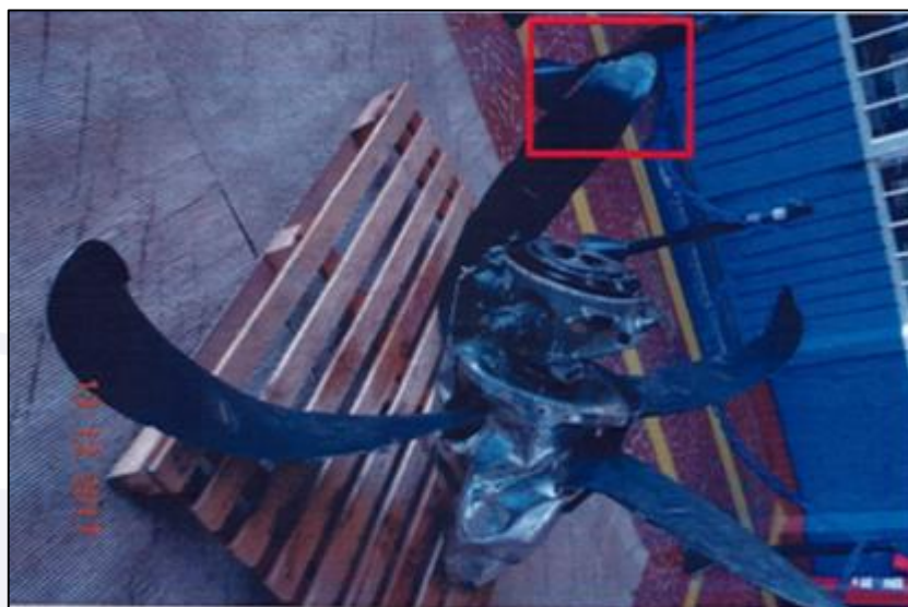
Figura 6 - Vista geral da hélice. O destaque mostra uma das pás dobrada para frente. As demais estavam voltadas para trás.
