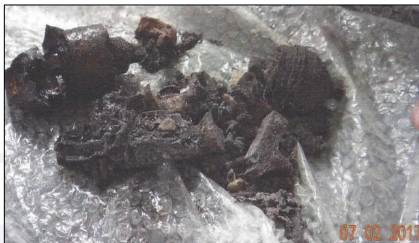
Figura 6 - Fragmentos do que restou dos magnetos do motor.
