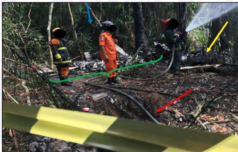
Figura 4 - Vista dos destroços da aeronave. A seta vermelha indica o barranco, local da segunda colisão; a seta amarela indica o motor e o conjunto de hélice; o colchete verde mostra o local onde foram encontrados os passageiros e a seta azul mostra o local que foi encontrado o piloto.
