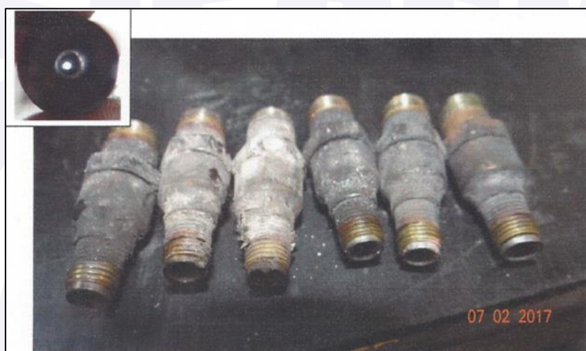
Figura 7 - Vista dos bicos injetores do motor. No destaque, é mostrado um dos bicos desobstruído.
