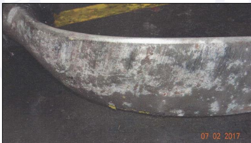
Figura 8 - Vista da pá com os riscos transversais.
