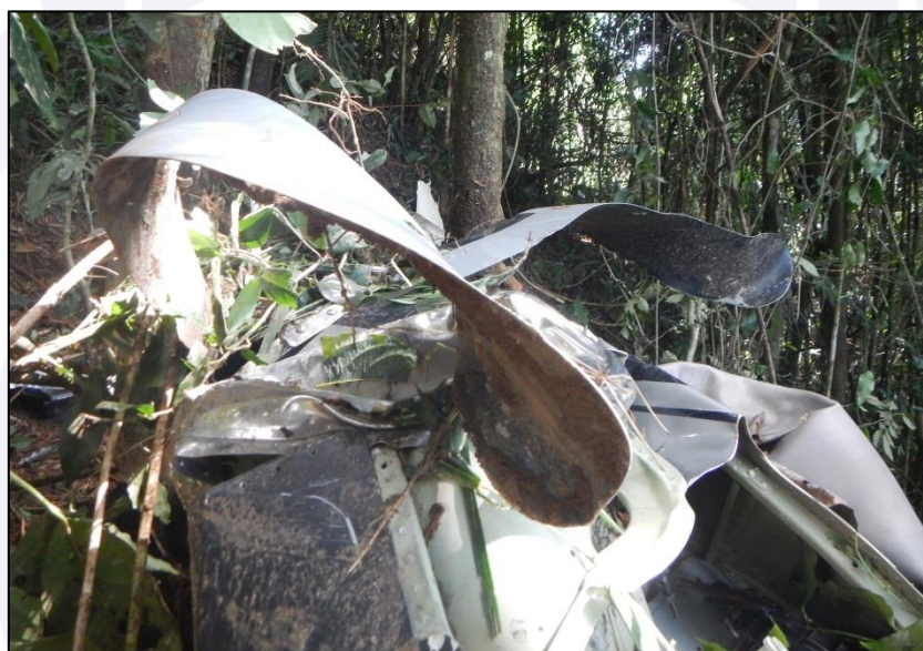
Figura 6 - Motor direito da aeronave com deformações na hélice.
