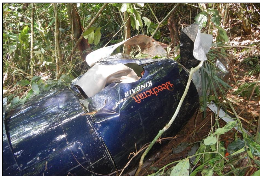
Figura 5 - Motor esquerdo da aeronave com deformações na hélice.
