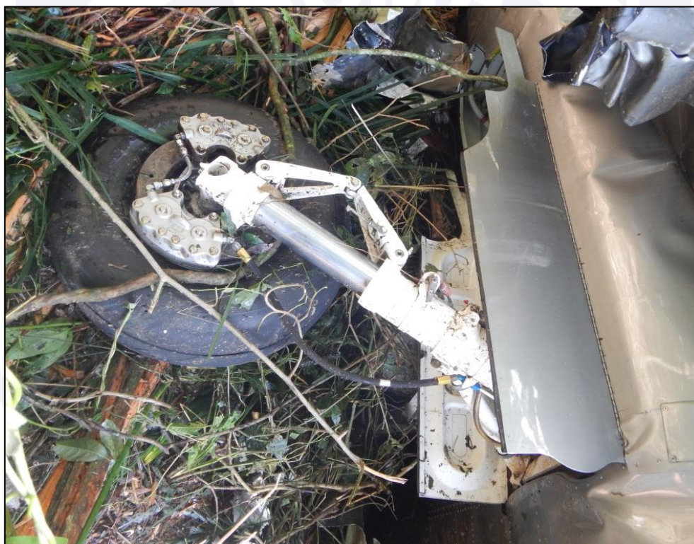
Figura 4 - Trem de pouso da aeronave fora de seu compartimento.
