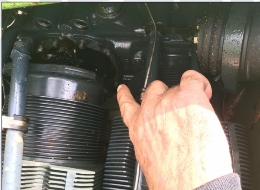
Figura 2 - Cilindro do motor desprendido do bloco.
