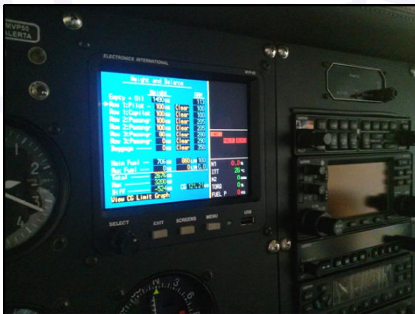
Figura 6 - Sistema de aviso do carregamento da aeronave, instalado em outro modelo de aeronave do fabricante do Kit.
