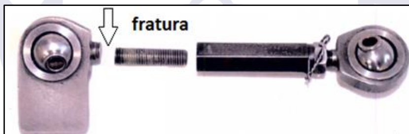
Figura 4 - Fratura da rosca próxima ao olhal.
