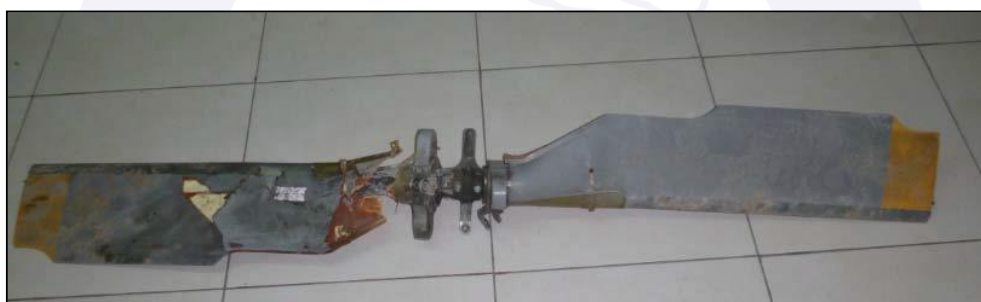
Figura 15 - Pás do rotor de cauda com danos compatíveis com o impacto da aeronave contra o solo.
