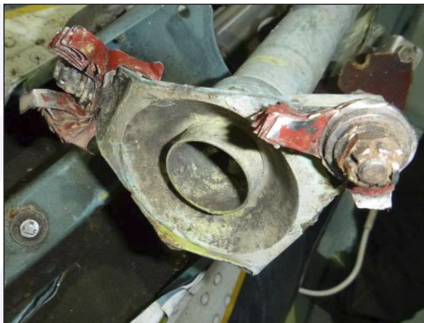
Figura 12 - Evidências de danos por sobrecarga nas partes restantes do flexible coupling do eixo de acionamento do rotor de cauda.
