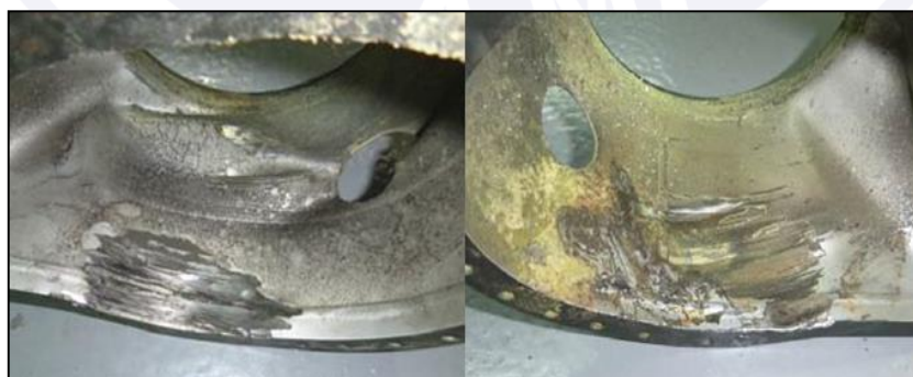
Figura 10 - Evidências de dano rotacional entre o tubo de conexão do motor e o eixo de saída do motor (conjunto da roda livre).
