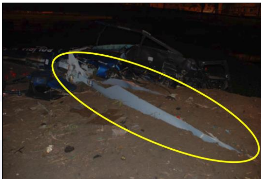
Figura 3 - Vista superior dos destroços, com destaque para duas pás do rotor principal parcialmente enterradas no terreno.
