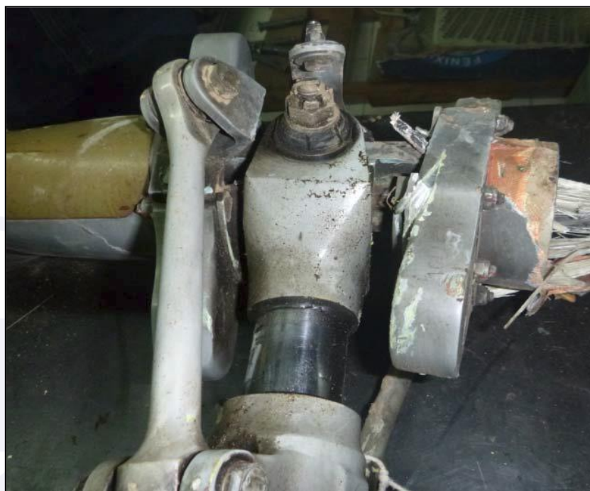
Figura 14 - Cabeça do rotor de cauda com danos compatíveis com o impacto da aeronave contra o solo.
