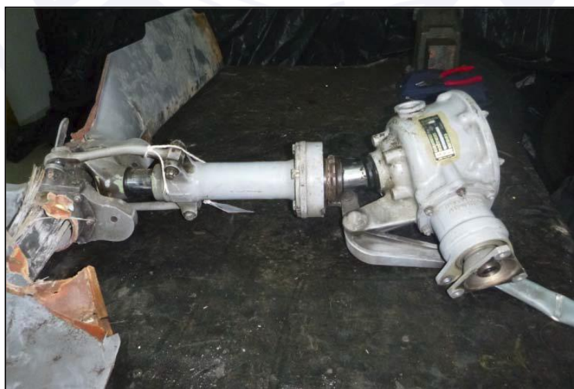
Figura 13 - Caixa de transmissão traseira com danos compatíveis com o impacto da aeronave contra o solo.
