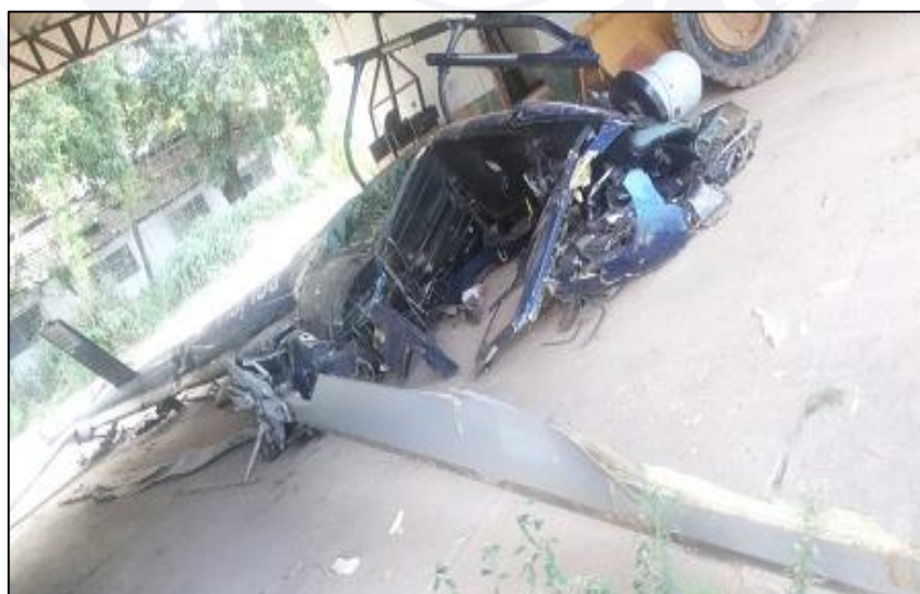
Figura 8 - Maiores danos à aeronave localizados no lado direito e com características de achatamento.
