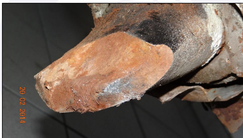
Figura 4 - Vista da fratura da primeira pá que colidiu contra o solo.
