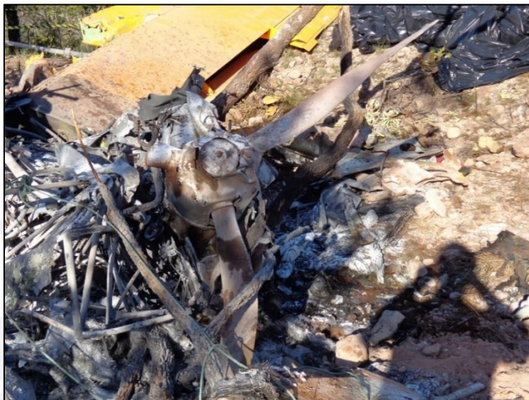
Figura 2 - Vista do motor evidenciando o colapso do berço.
