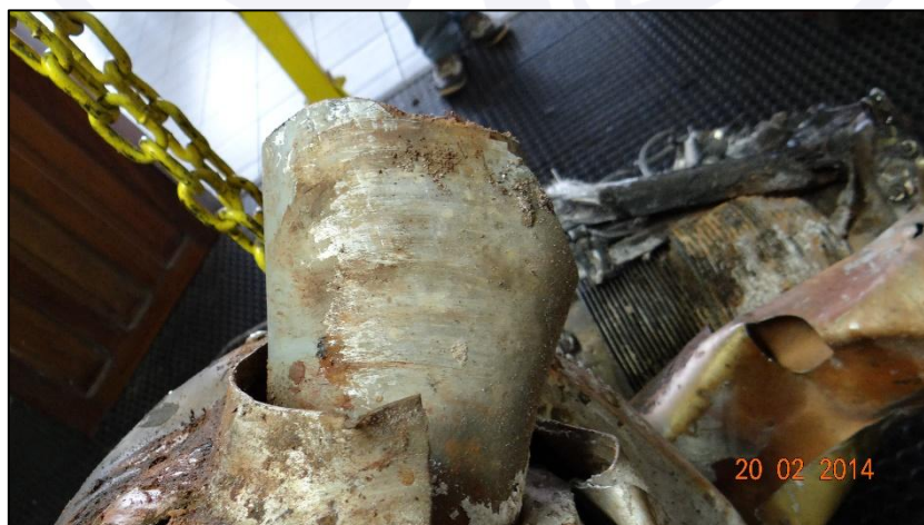
Figura 4 - Vista da fratura da primeira pá que colidiu contra o solo.
