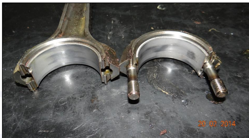
Figura 3 - Evidências do bom estado das bronzinas do motor.
