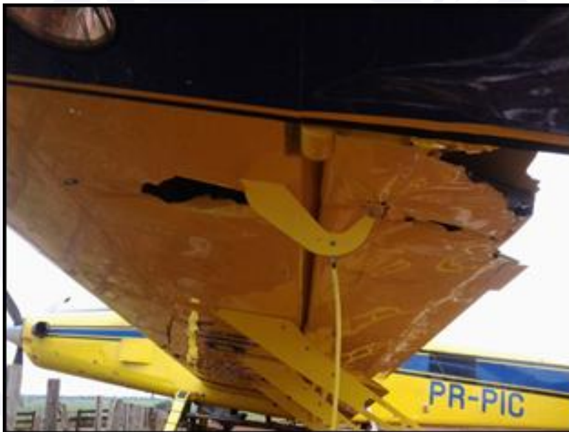
Figura 2 - Danos ao intradorso da asa esquerda e ao aileron esquerdo.
