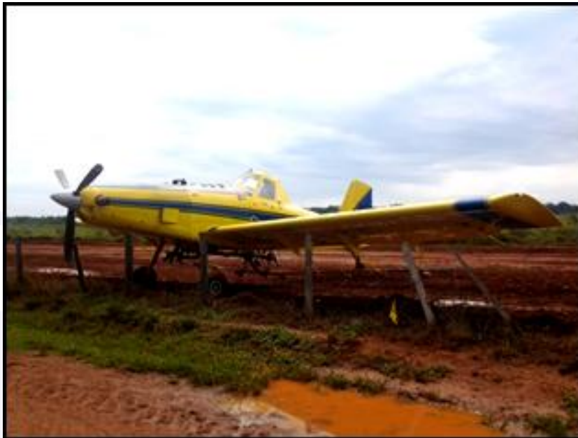
Figura 7 - Estacas de madeira atingidas pela aeronave.
