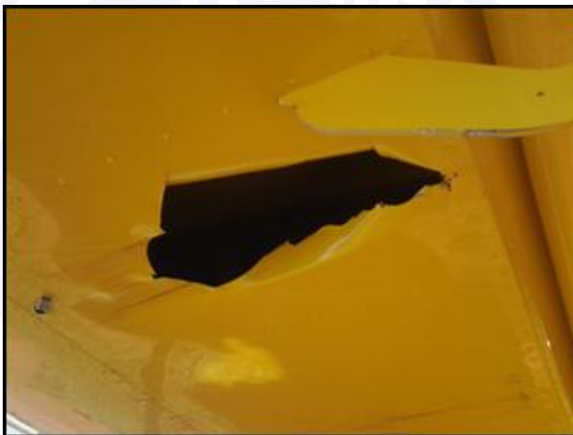
Figura 8 - Perfuração do intradorso da asa esquerda.
