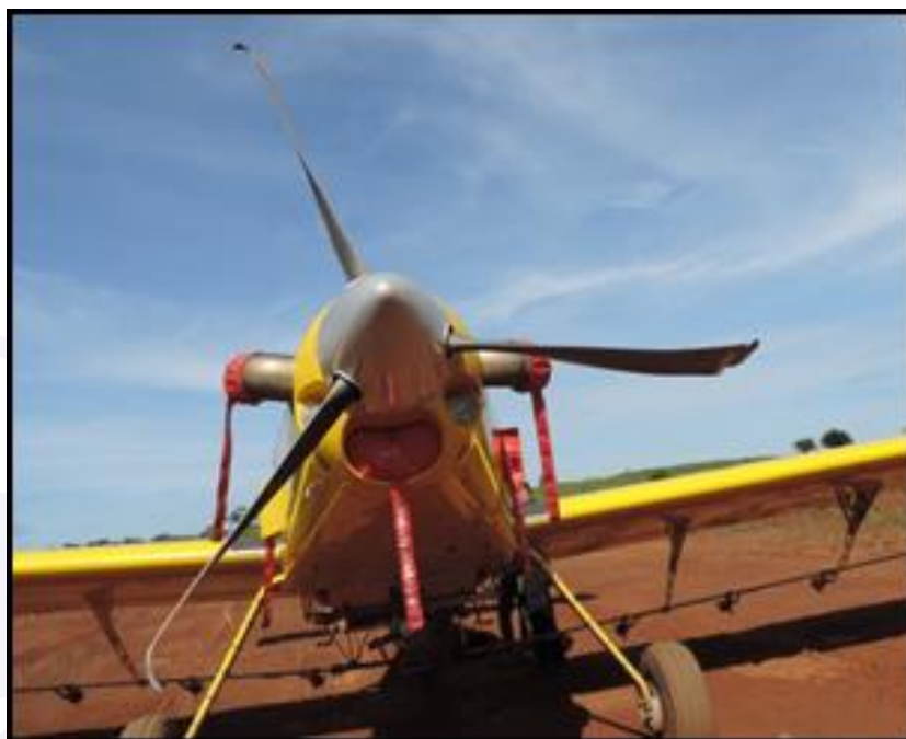
Figura 9 - Pontas das pás da hélice danificadas.
