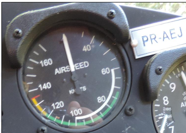
Figura 8 - Velocímetro da aeronave graduado em kt e com as marcações de faixas de operação e VNE.
