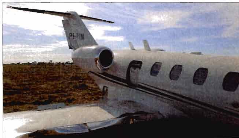
Figura 18 - Vista da saída de emergência e da entrada de ar do motor direito.
