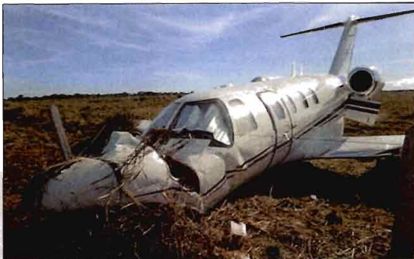
Figura 5 - Danos à seção dianteira da aeronave.
