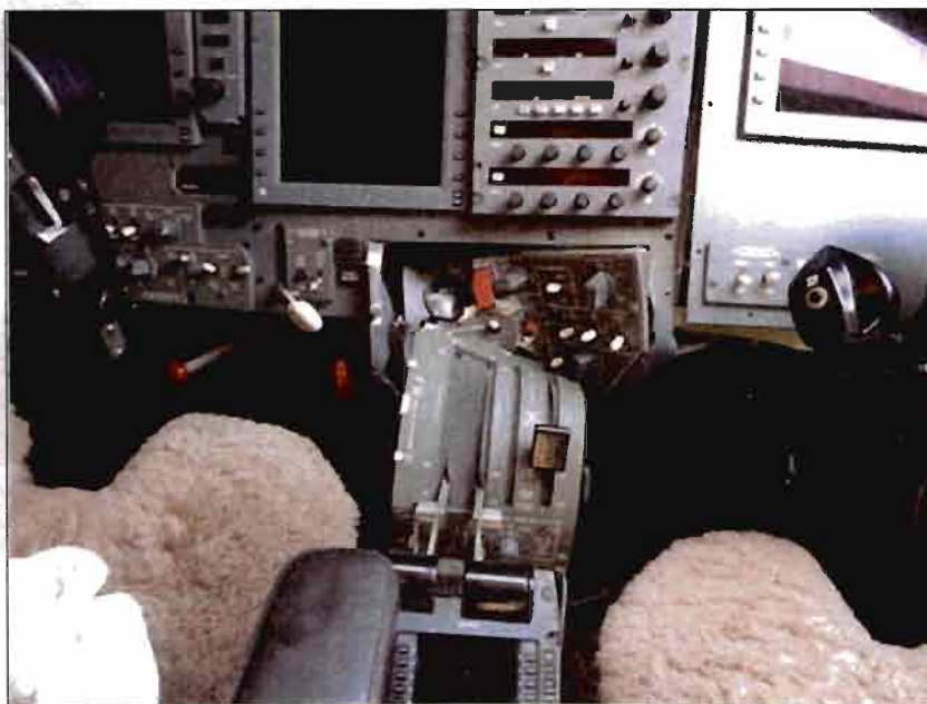
Figura 6 - Deformações no painel da aeronave e no console de manetes. O manete do motor direito já aparece reposicionado após a ação da equipe de bombeiros.
