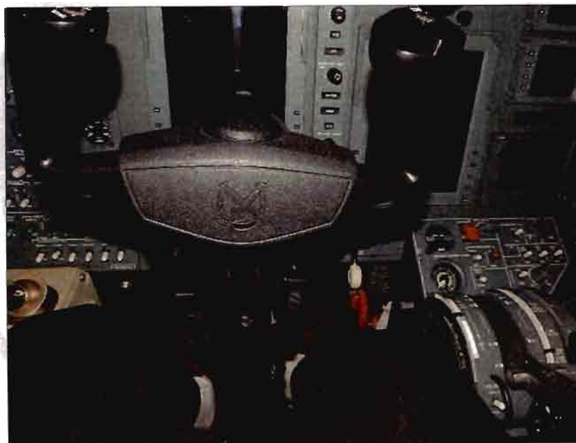
Figura 15 - Visão do painel para o piloto posicionado no assento da esquerda do Cessna 525 . A visualização do punho de acionamento do freio de emergência encontra-se obstruída pela coluna do manche.
