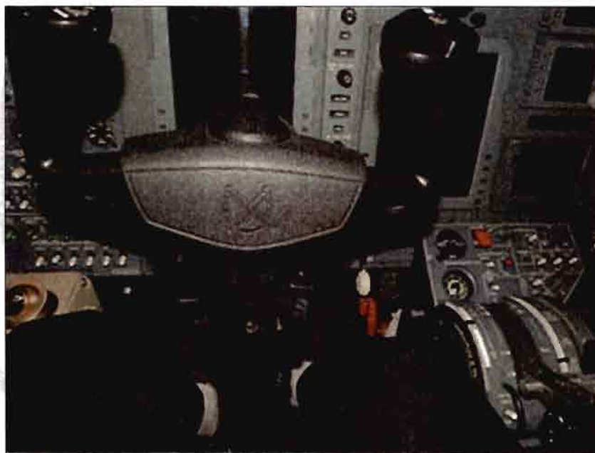
Figura 28 - Visão do painel para o piloto posicionado no assento da esquerda do Cessna 525. A visualização do punho de acionamento do freio de emergência encontra-se obstruída pela coluna do manche.
