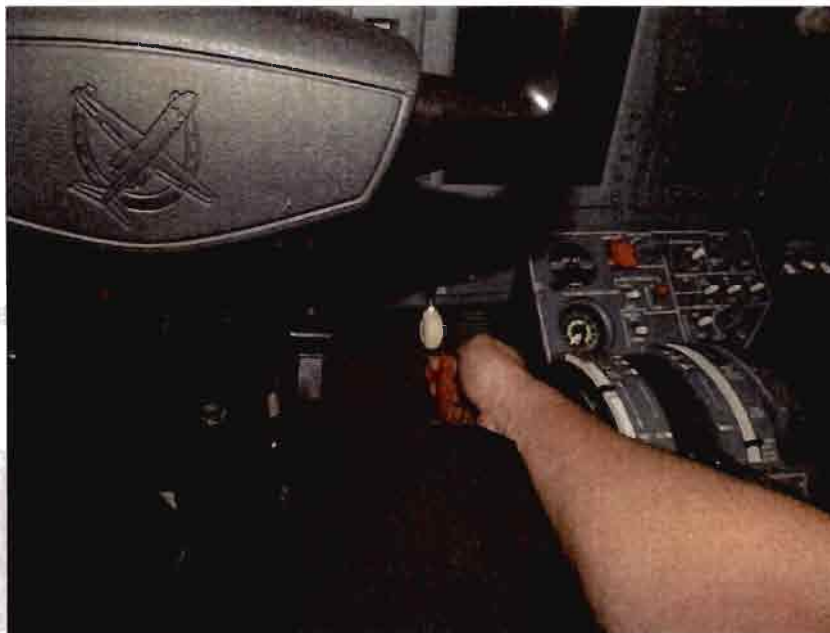
Figura 16 - Visualização da alavanca de acionamento do trem de pouso por emergência pelo piloto posicionado no assento da esquerda.
