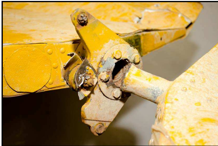
Figura 16 - Detalhe da região fraturada.
