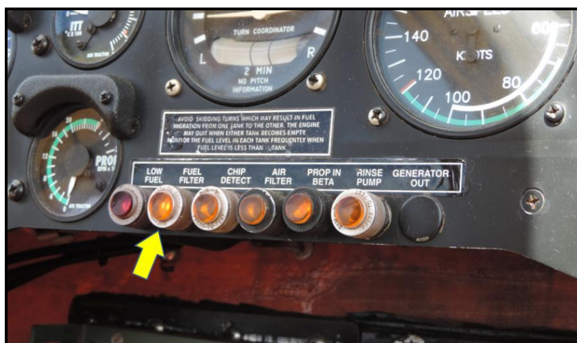
Figura 4 - Luz de alarme Fuel Filter .
