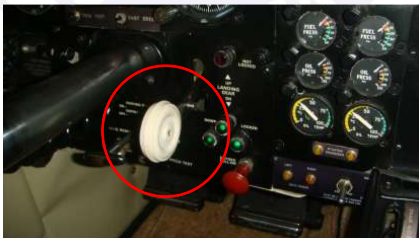
Figura 2 – Posição da alavanca de comando do trem de pouso e seus detalhes.
