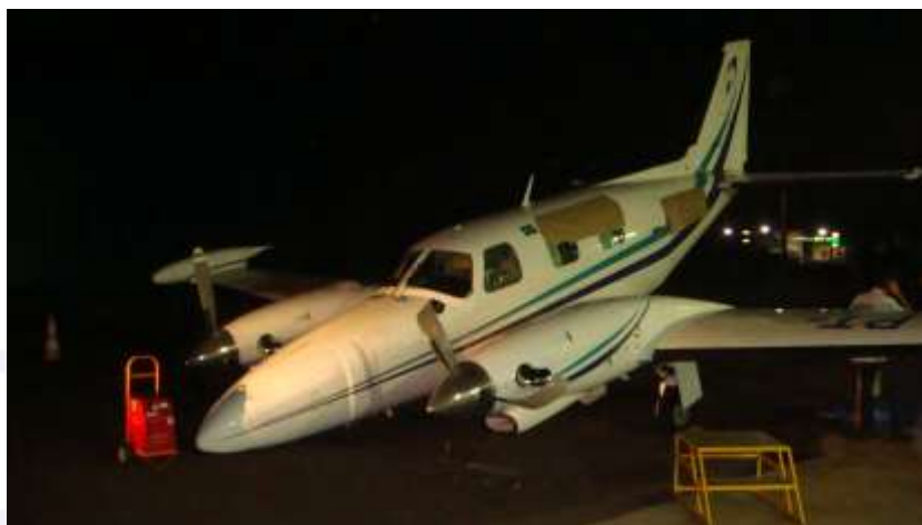
Figura 1 – Posição da aeronave após o recolhimento da bequilha.
