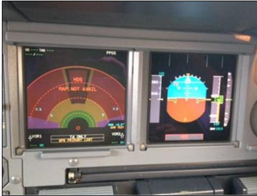
Figura 10 - Teste operacional de varredura da antena do radar meteorológico.
