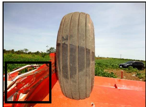
Figuras 4 e 5 - Marca do cabo de aço no pneu direito da aeronave e danos causados à perna do trem de pouso.
