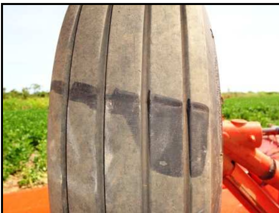
Figuras 4 e 5 - Marca do cabo de aço no pneu direito da aeronave e danos causados à perna do trem de pouso.
