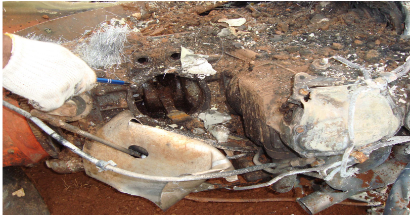
Figura 2 - Ausência do cilindro nº2 no motor.
