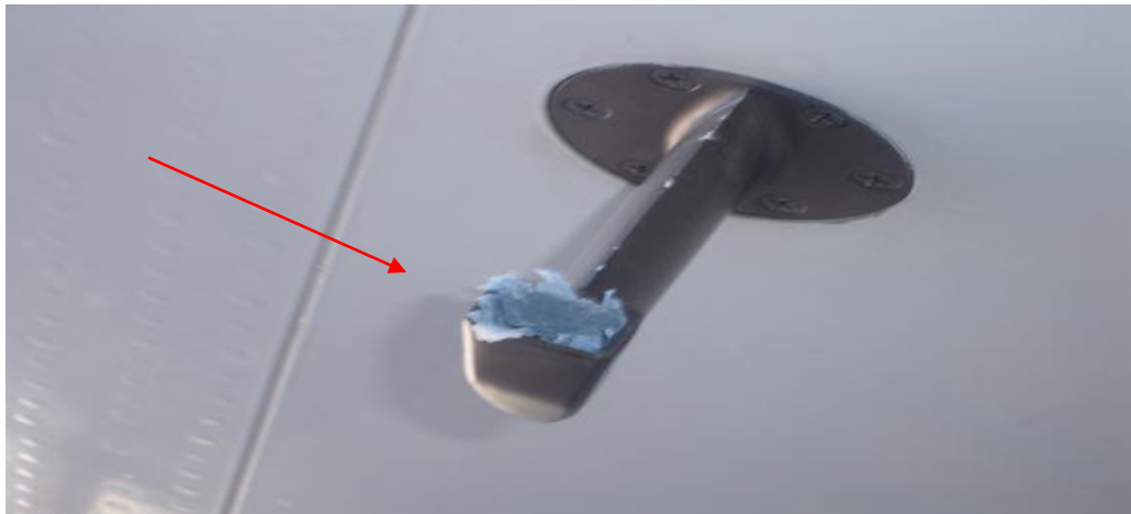
Figuras 2 - TAT sensor obstruído por plástico.
