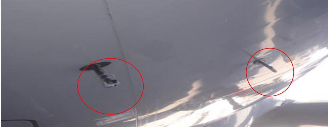
Figura 1 - Resíduos de plástico do "banner" no TAT sensor e Tubo de Pitot.
