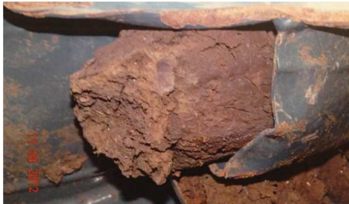
Figura 11 – Terra compactada observada na saída de ar do FAN para a refrigeração do motor.
