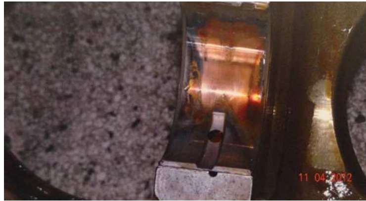
Figura 13 – Vista aproximada da bronzina do mancal 3.
