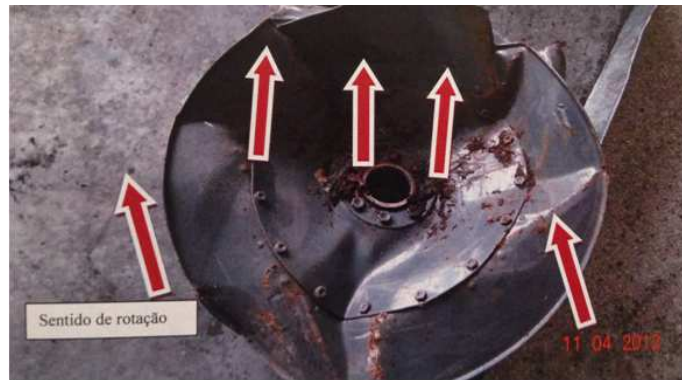
Figura 10 – Vista traseira do FAN mostrando as deformações por torção.
