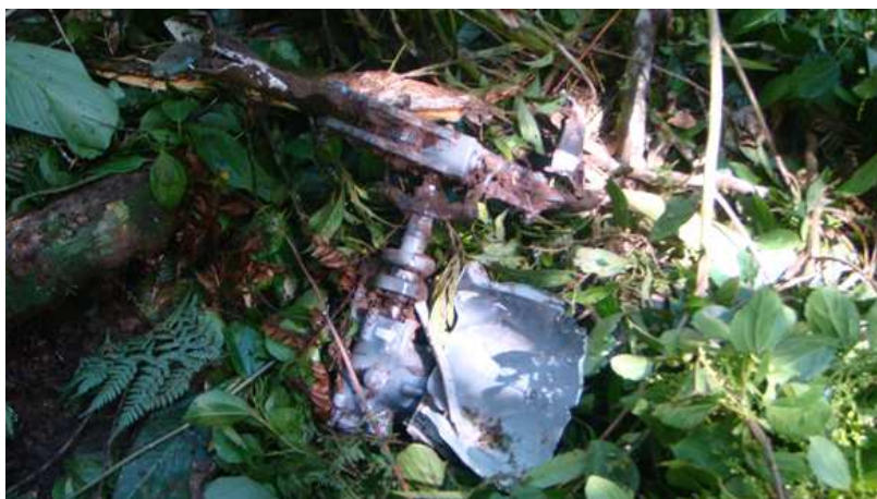
Figura 7 – Vista do rotor principal.
