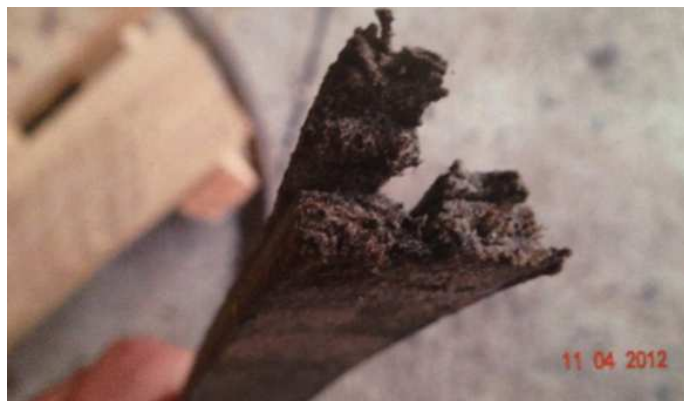
Figura 12 – Vista da correia de transmissão de potência rompida por sobrecarga.
