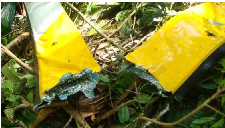
Figura 6 – Vista de uma das pás rompidas após o impacto.
