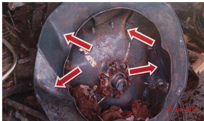
Figura 9 – Vista mostrando as deformações por torção.
