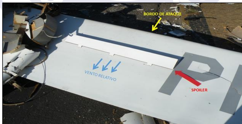
Figura 3 - Spoiler acionado na asa esquerda.
