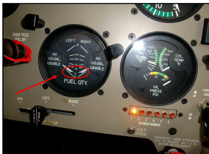
Foto 08 – Liquidômetro com cerca de 4,5 galões remanescentes em cada tanque.
