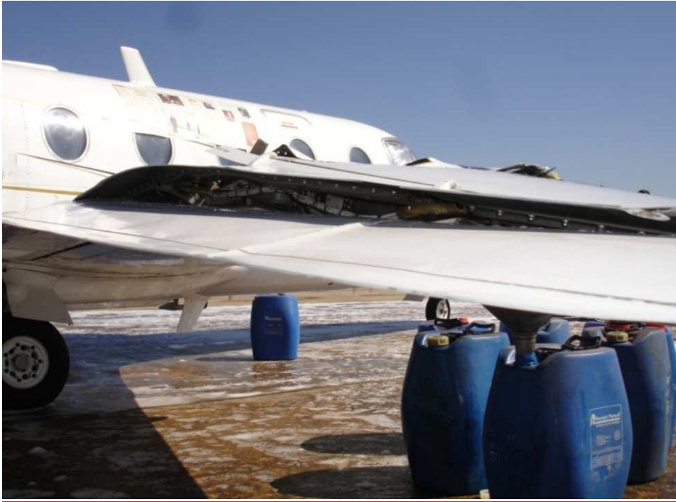
Foto nº 2: Aeronave estacionada após a ocorrência, sendo visível o dano sofrido na asa esquerda.
