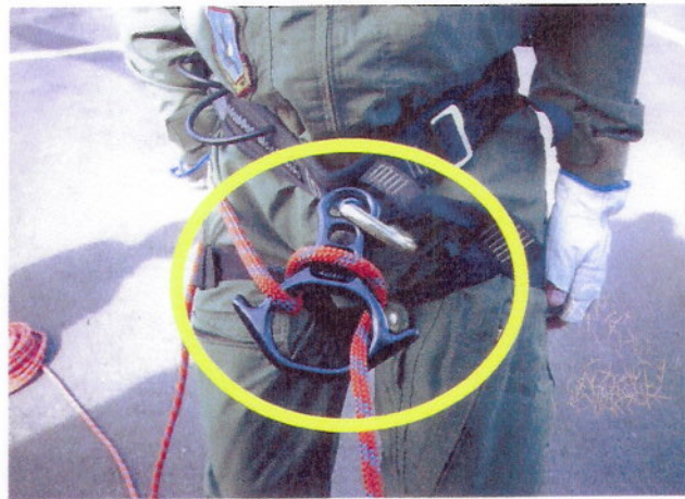
Figura nº 9 Freio em oito pressionando a capa da rosca do mosquetão
