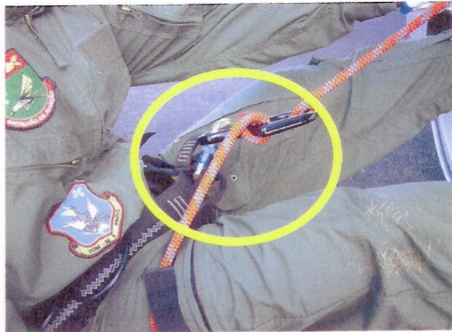
Figura nº 11 Freio em oito continua pressionando a capa da rosca do mosquetão.
