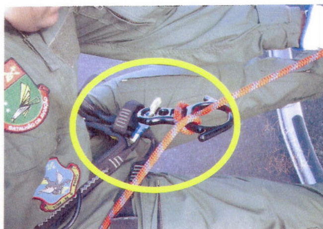
Figura nº 10 Freio em oito pressionando a capa da rosca do mosquetão
