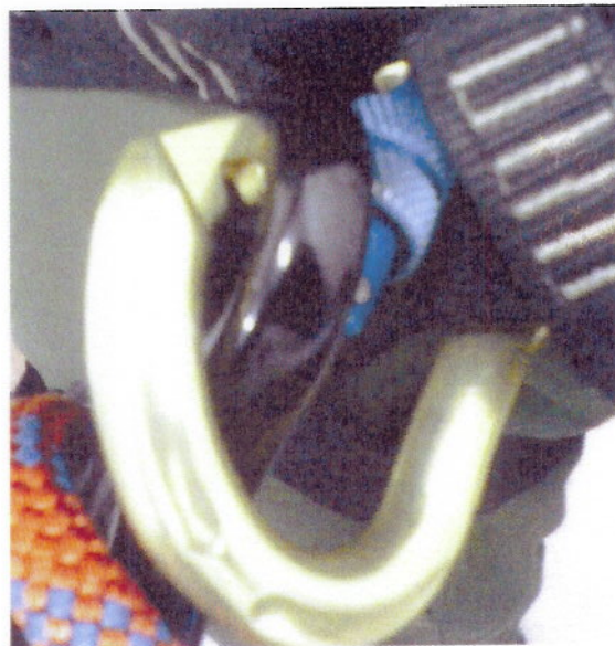
Figura nº 12 Freio em oito pressionando a capa da rosca do mosquetão
