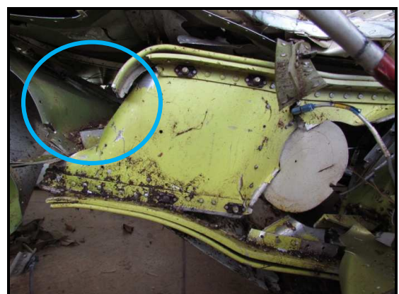
Figuras 11 e 12 - Ponto de ruptura da asa direita.
