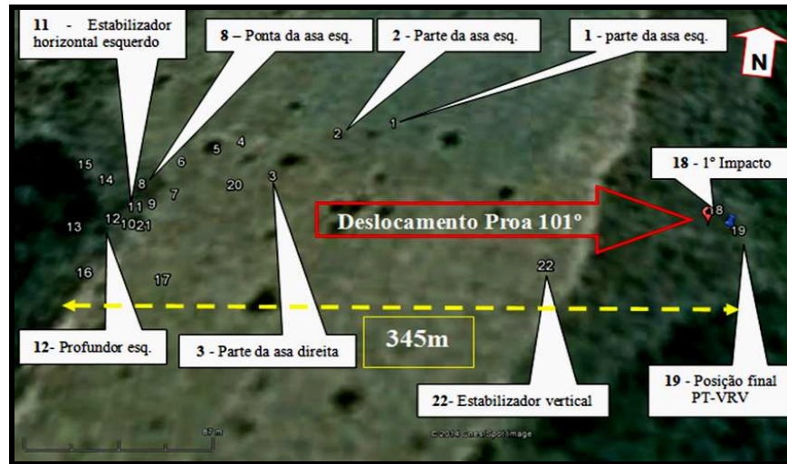
Figura 6 - Distribuição dos componentes da aeronave no solo.
