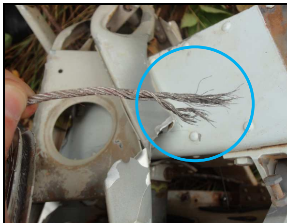
Figura 16 - Cabo do leme direcional da aeronave com característica de ruptura por sobrecarga.
