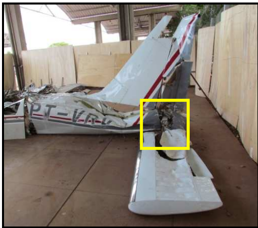
Figuras 14 e 15 - Ponto de ruptura e fratura do estabiprofundador com características de sobrecarga.
