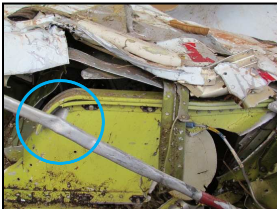
Figuras 11 e 12 - Ponto de ruptura da asa direita.
