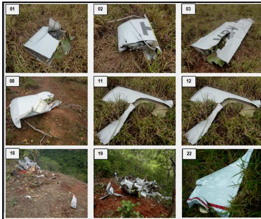
Figura 7 - Principais partes da aeronave que se soltaram em voo.
