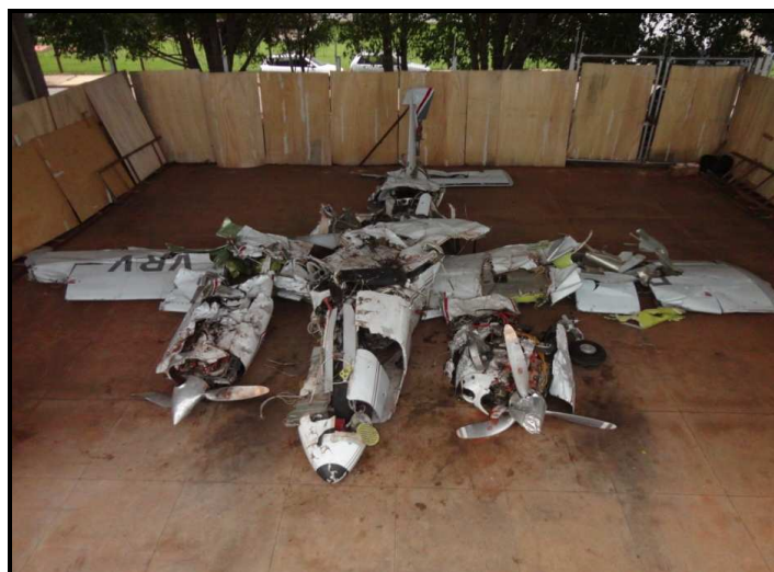
Figura 9 - Remontagem dos destroços da aeronave.
