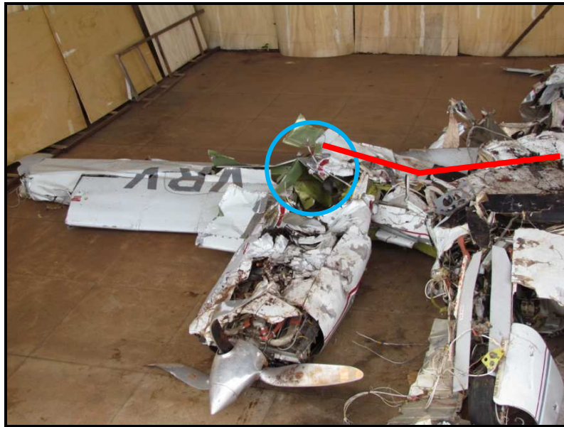
Figura 10 - Asa direita com a flexão da estrutura para cima (linha vermelha).
