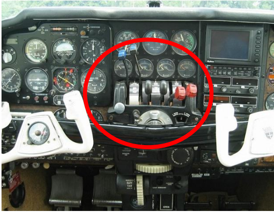
Foto 06: posição das manetes de hélice (azuis) no modelo 95-B55. (esquerda)
