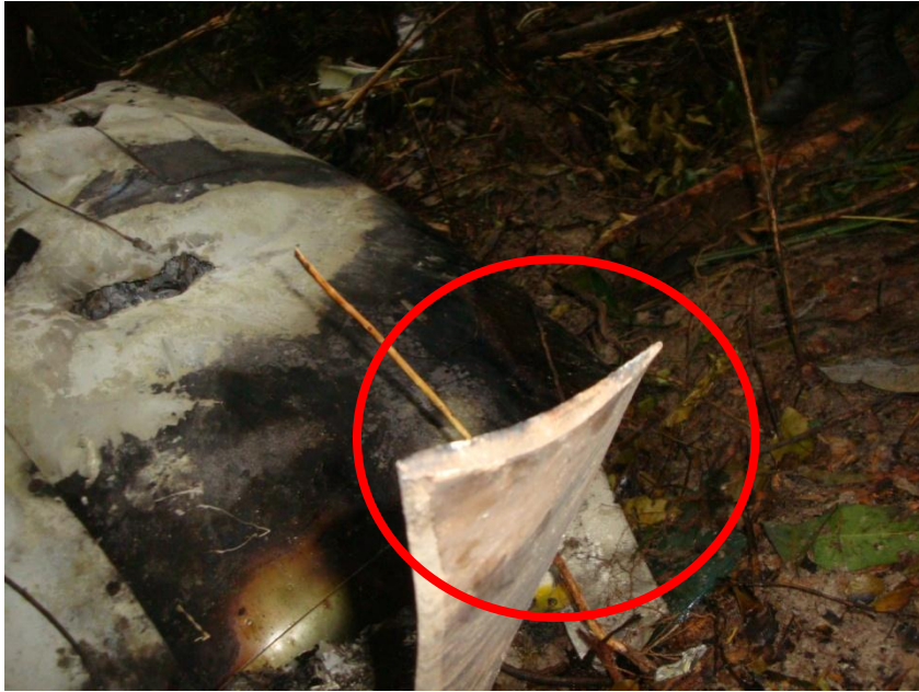
Foto 05: Pá da hélice esquerda com avaria (corte) próxima à ponta.
