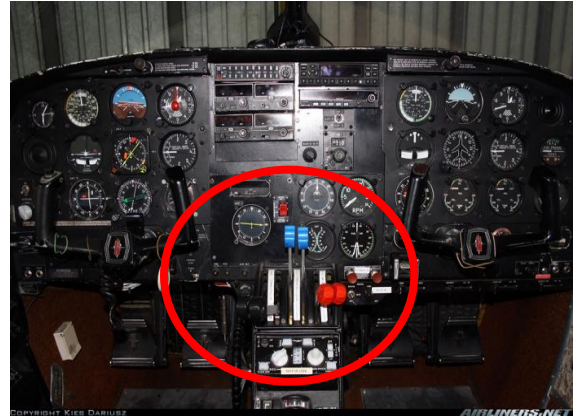
Foto 06: posição das manetes de hélice (azuis) no modelo 95-B55. (esquerda)
