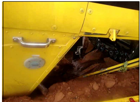
Figuras 9 e 10 - As treliças de reforço da cabine impediram que o peso da aeronave esmagasse o piloto e comprimisse a porta de acesso à cabine em posição invertida, parcialmente soterrada.
