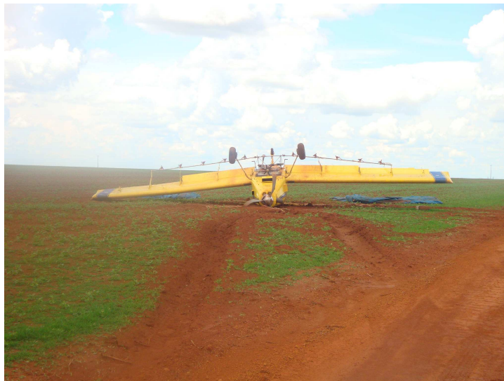
Figura 8 - Piso da área de escape da pista com baixo nível de compactação, conforme indicação.
