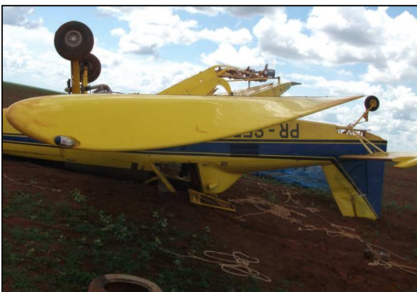
Figuras 9 e 10 - As treliças de reforço da cabine impediram que o peso da aeronave esmagasse o piloto e comprimisse a porta de acesso à cabine em posição invertida, parcialmente soterrada.
