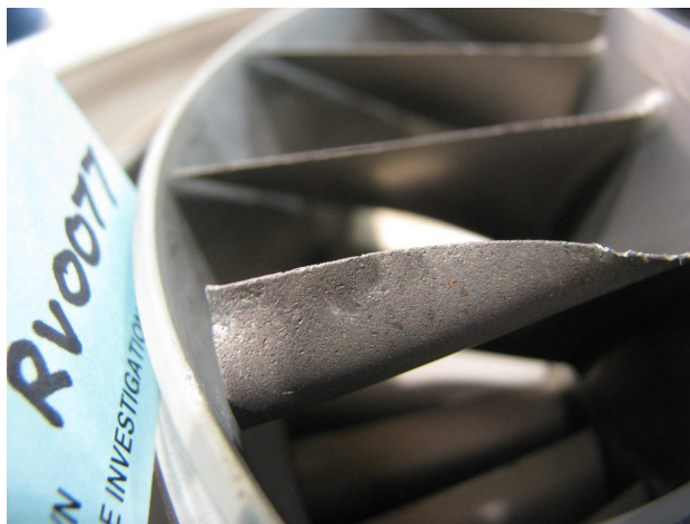
Figuras 4 e 5 - Vista aproximada da deformação e impacto nas demais pás.
