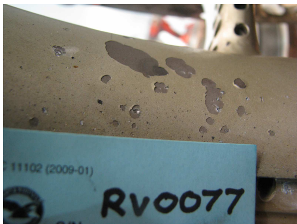
Figuras 2 e 3 - Marcas de impacto na entrada de ar do compressor.
