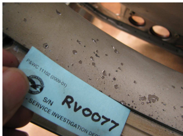
Figuras 2 e 3 - Marcas de impacto na entrada de ar do compressor.
