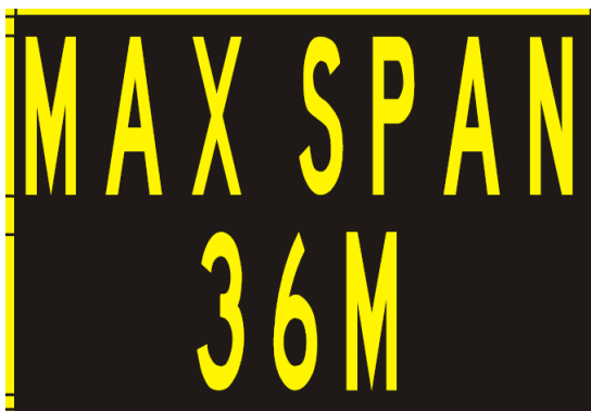
Figuras 6 e 7 – Marcação padrão adotada pela ACI e a marcação na pista de táxi R antes do ingresso na pista de táxi L4.
