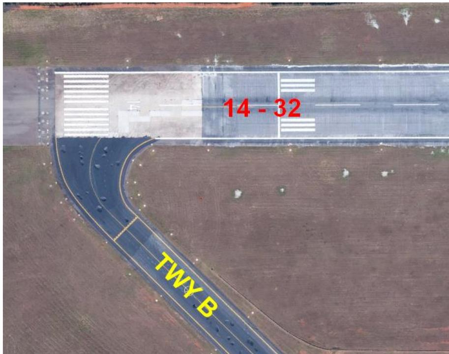
**Figura 1 – Pista de táxi de acesso não permite visualização de toda a pista.**
