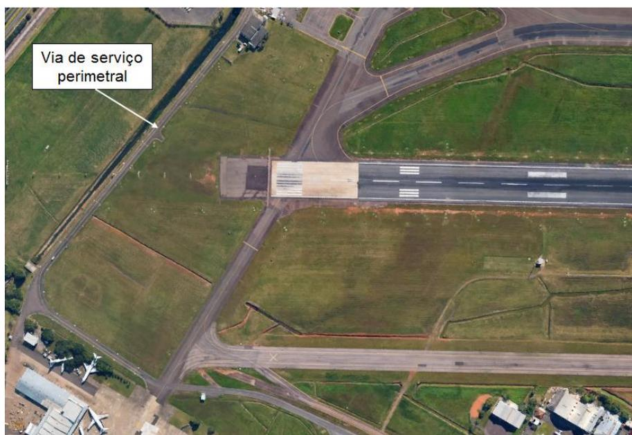
Figura 4 – Via de serviço construída além da cabeceira
