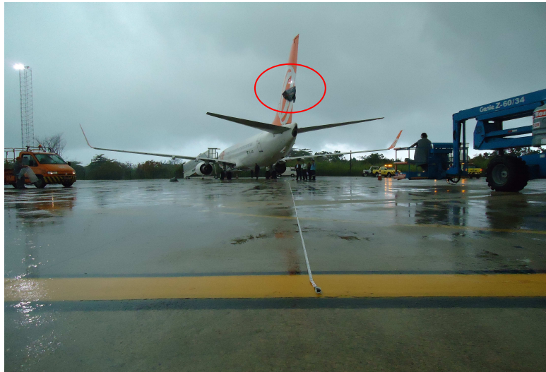
Figura 6 – Danos no estabilizador vertical da aeronave B737 após a colisão, demonstrando a distância da Yellow Line seguida pelo o B777 durante o taxi in .
