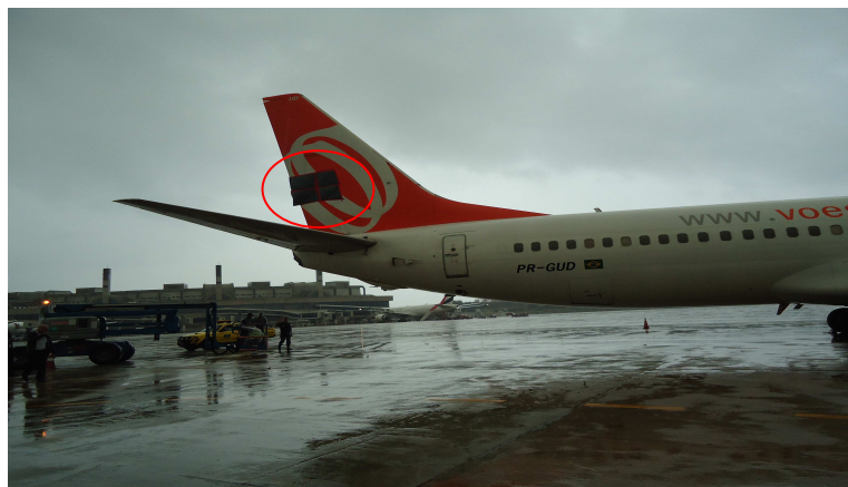
Figura 7 – Danos no estabilizador vertical da aeronave B737 após a colisão.
