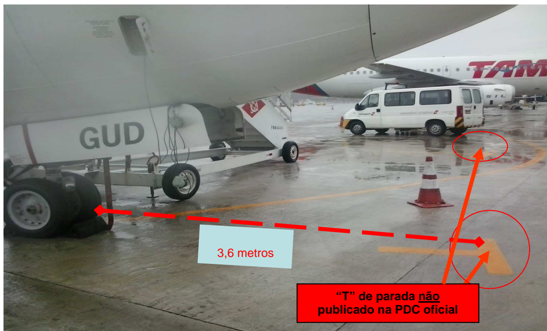
Figura 3 – Posição das marcações no pátio em desacordo com o descrito na PDC publicada pelo DECEA. Posição da aeronave atingida (3,6 metros recuada da marcação no pátio).
