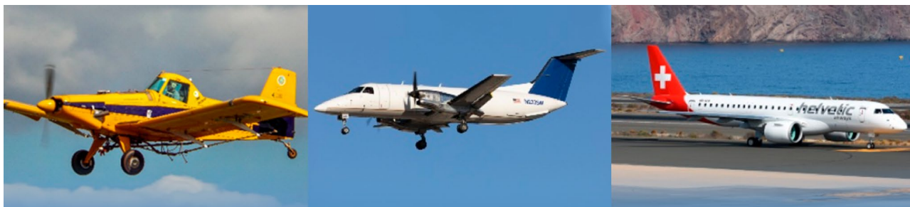
Figura 16: exemplos de aeronaves – da esquerda para a direita: aeronave a pistão, aeronave turboélice e aeronave a jato.
