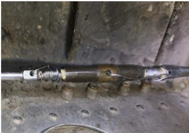
Figura 2 – Configuração com o arame de freio.
