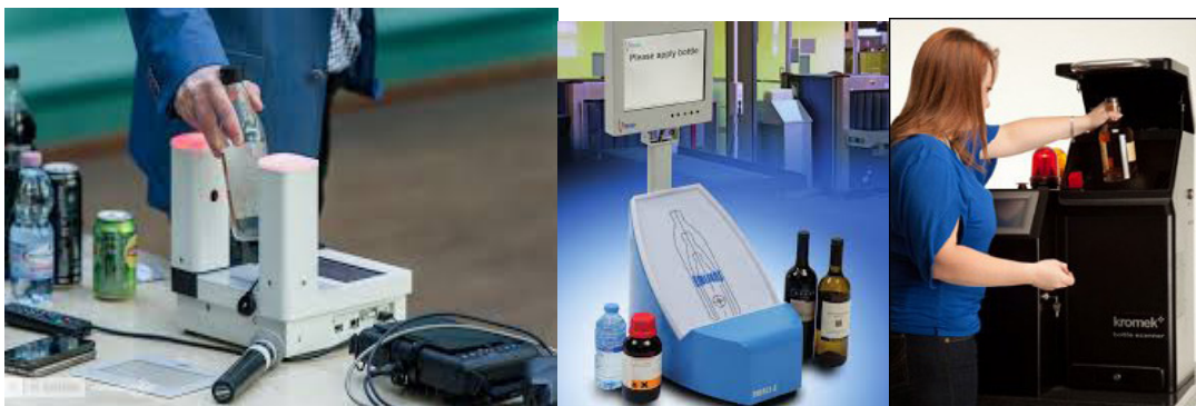
Figura 2 – Exemplos de equipamentos que detectam LAGs sem utilização de amostras.
