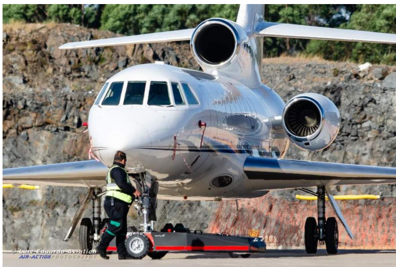
Figura 2. Aeronave acoplada a rebocador elétrico no São Paulo Catarina Aeroporto Executivo Internacional – Cortesia: JHSF
