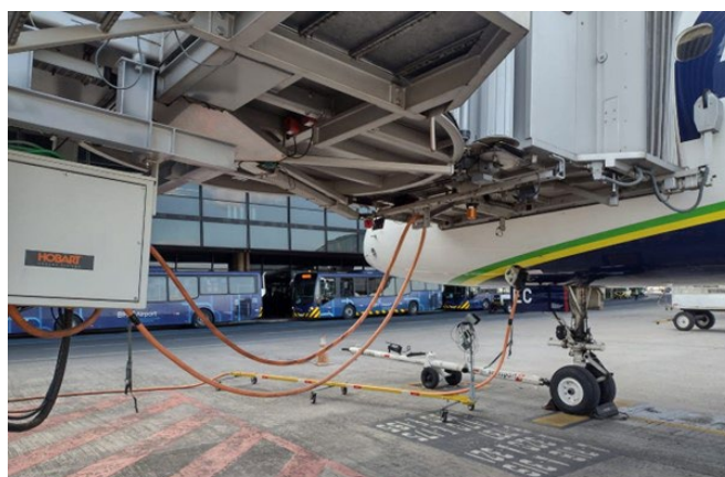
Figura 1. Aeronave alimentada com eletricidade fornecida pelo Aeroporto Internacional de Confins – Cortesia: BH Airport
