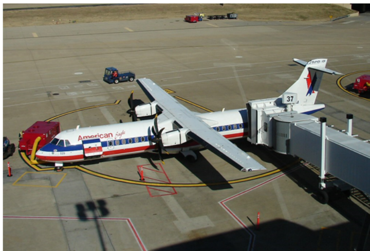
Figura 7: Aeronave ATR 72 operando em ponte de embarque
