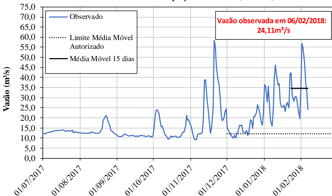
POSTO DE CONTROLE - Captação de Valinhos (3D-007T)
